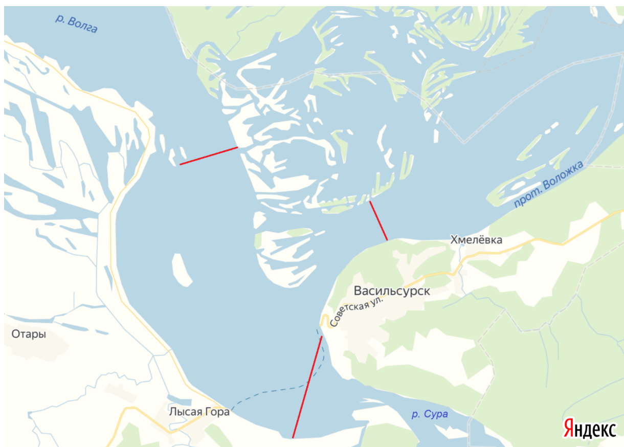
Рис. 1. Сечения, в которых выполнялось зондирование и отбор проб, в районе устья р.Сура.
